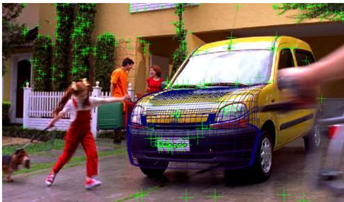
Imatge 57. Exemple del rastreig de punts específics per al match moving.
