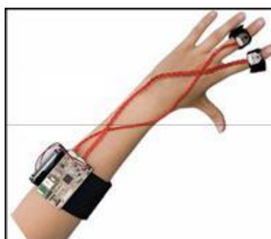
Aparellatge utilitzat per mesurar la Resposta galvànica de la pell
