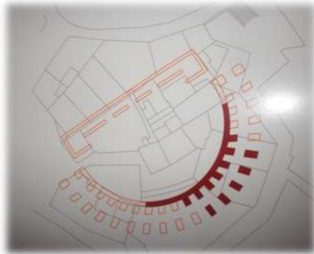
Planta del teatre amb les restes conservades (en vermell més fort), on es poden apreciar el mur semicircular i les fonamentacions radials.
